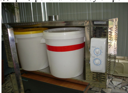
Рисунок 2 – Микроволновая установка «УОМО – 01/150-О-ЦНТ»
